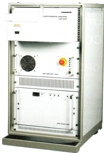
Лазерный анализатор элементного состава LEA-S500
